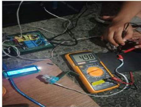
Gambar 5. Pengukuran Tegangan Sensor Turbidity
