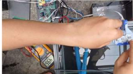
Gambar 6. Pengukuran Tegangan Sensor Ultrasonik
